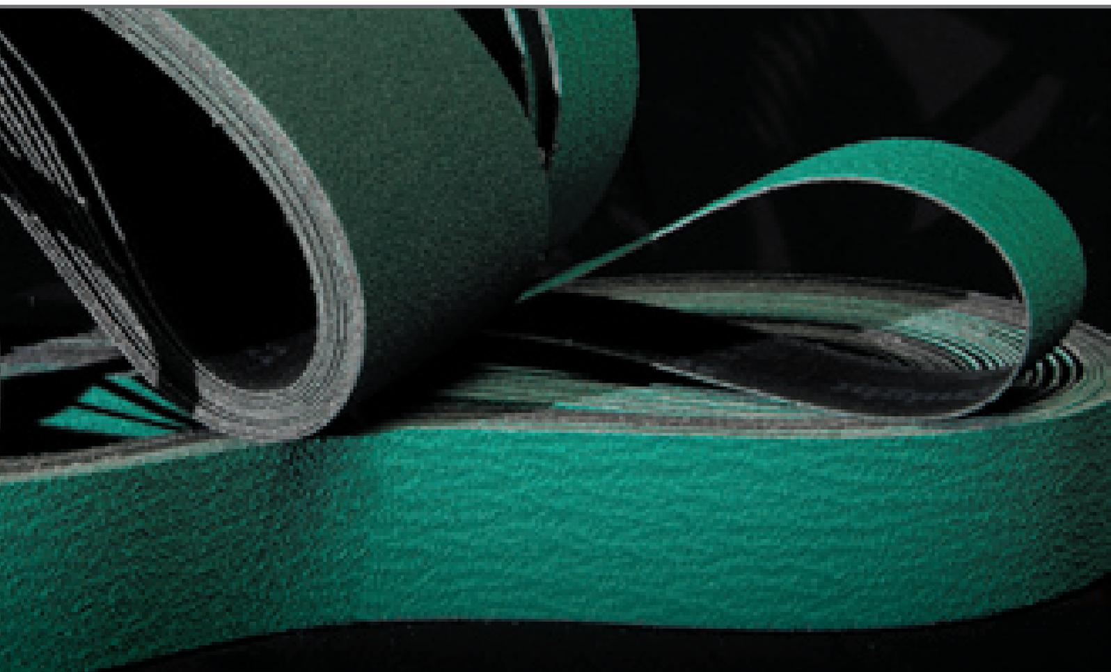
Les bandes abrasives BIBIELLE sont réalisées avec assemblage tête à tête et film renforcé jusqu'à une hauteur de 350 mm. Pour les hauteurs dépassant cette mesure, l'assemblage superposé est employé.
